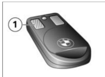
Si tiene que activarse la función de alarma después de que haya transcurrido más de un minuto después de desconectar el encendido, la tecla **1** debe pulsarse durante más de un segundo. Después de aprox. una hora en estado desactivado, el DWA se desconecta para ahorrar batería. Para activar la función de alarma después de ese periodo debe activarse y desactivarse de nuevo el encendido.
