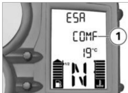
La amortiguación ajustada se visualiza en la pantalla multifunción, en la zona **1**. Los indicadores tienen el significado siguiente:
