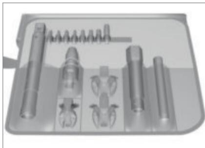
Para los trabajos ampliados (por ejemplo, desmontaje y montaje de ruedas), BMW Motorrad ha confeccionado un juego de herramientas de servicio para su motocicleta. Obtendrá este juego de herramientas de servicio en su Concesionario BMW Motorrad.
