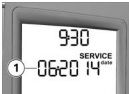
Si el tiempo restante hasta el siguiente servicio de mantenimiento es inferior a un mes, la fecha del servicio de mantenimiento **1** se mostrará brevemente, a continuación, en el pre-ride check. El mes y el año se representan separados por dos puntos con 2 o 4 caracteres. En este ejemplo, la indicación significa "junio de 2014".
