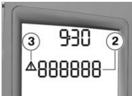
Además, al lado de la zona de valores **2** se puede visualizar el triángulo de advertencia **3**. Estas advertencias y los cuentakilómetros (▬► 52) se muestran de forma alternada.
