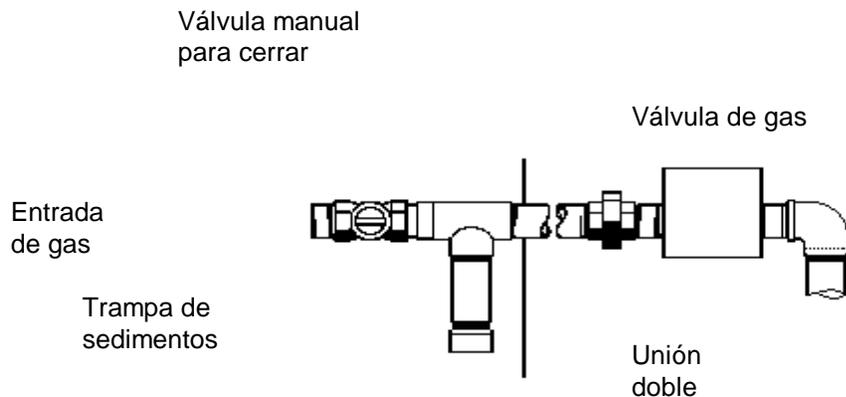
La cañería de gas debe tener una trampa para sedimentos, y una válvula de cierre ubicada en las inmediaciones del equipo.
