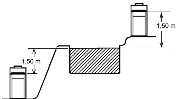
Si el desnivel supera estos valores se deberá utilizar un control que actúa en base al caudal y no a la presión del agua circulante, llamado flow-switch. Este habilitará el quemador solo cuando detecta el caudal necesario.
