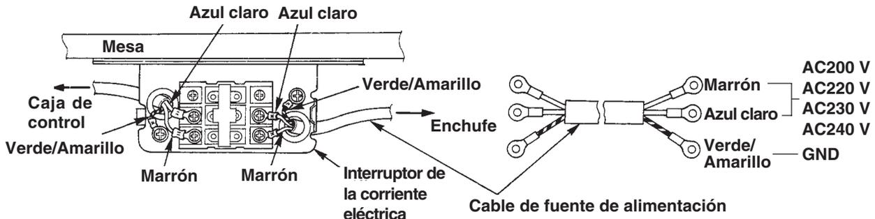
**• Modo de conectar las tensiones trifásicas 200V, 220V y 240V**
