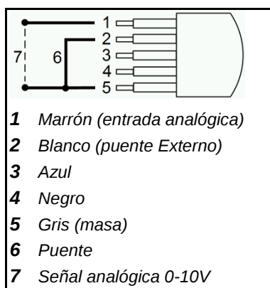
Fig. 18: Puente de cable RC
