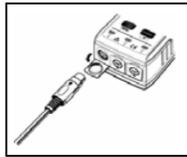
1. Conecte la mordaza al instrumento firmemente, con especial atención a la orientación del conector.
