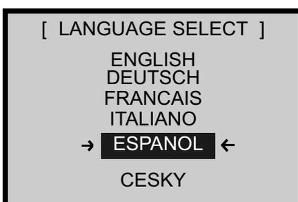
El cargador POWER PEAK I4 EQ-BID está equipado con una guía de menú multilingüe. Para seleccionar el idioma deseado, pulsar y mantener pulsada la tecla 'MODE' después de ajustar la tensión de entrada y el test del LED (todos los LEDs en los sensores táctiles se iluminan y vuelven a apagarse). A continuación aparece la indicación
