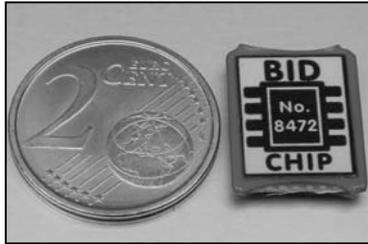
BID-chip sin cable, para equipar otras baterías No. 8472
