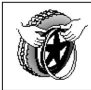
Ponga la cámara deshinchada alrededor del centro de la llanta. Compruebe que la válvula salga por el orificio de la válvula de la llanta.
