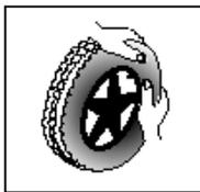
Si la cámara cabe bien dentro del neumático sin pliegues (si hubiera pliegues, deshínchela un poco), la parte superior del neumático puede presionarse ligeramente en la llanta con ambas manos, empezando por la válvula.
