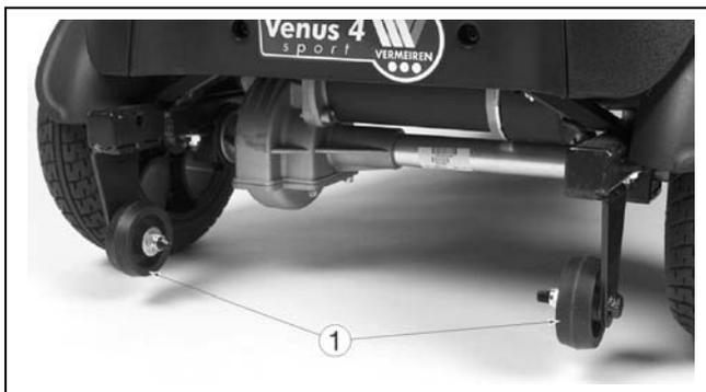
El antivuelco ① está fijado en la parte posterior del armazón del scooter, por lo que no es posible extraerla. Por lo tanto, no es posible retirarlo. El antivuelco está diseñado para su seguridad. Evita que el scooter vuelque hacia atrás cuando supere obstáculos pequeños que NO excedan la altura máxima especificada.
