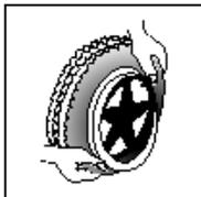
Presione el neumático sobre la llanta, empezando por detrás de la válvula. Hínche la cámara ligeramente hasta que empiece a redondearse y colóquela dentro del neumático.
