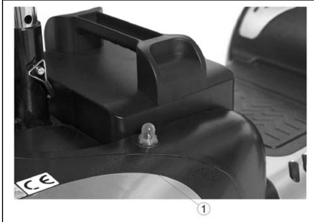
Con el fin de proteger el motor de una posible sobrecarga, el scooter cuenta con un mecanismo de seguridad térmica ① en la parte derecha del alojamiento de la batería. El fusible térmico parará el motor automáticamente para evitar el recalentamiento, el deterioro rápido o las averías. Puede acceder al dispositivo térmico de seguridad a través de un orificio situado en la parte posterior de la cubierta sintética.
