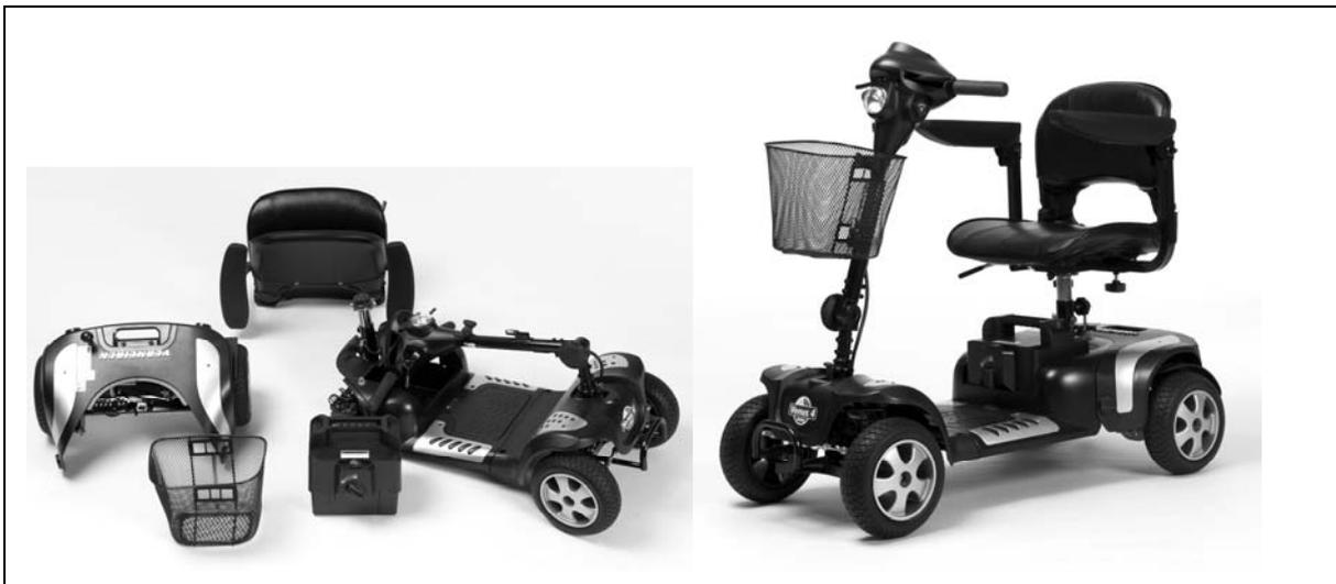
El scooter se puede desmontar en 4 partes, el asiento (peso 5,6 kg), chasis delantero (peso 19,90 kg), chasis trasero (12,85 kg) y carcasa de baterías (13,60 kg), sin herramientas.
