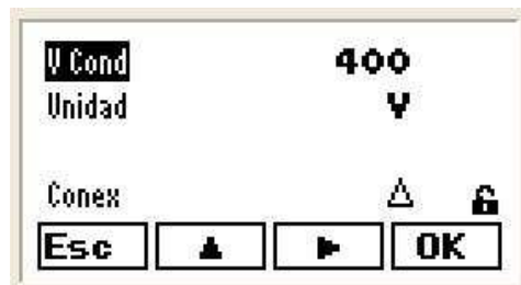
Fig.25.- Programación de la configuración de los condensadores
