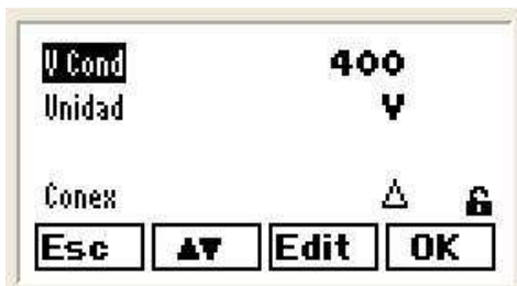
Fig.24.- Programación de la configuración de los condensadores
