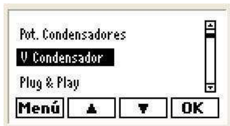
Fig.22.- Programación de la configuración de los condensadores
