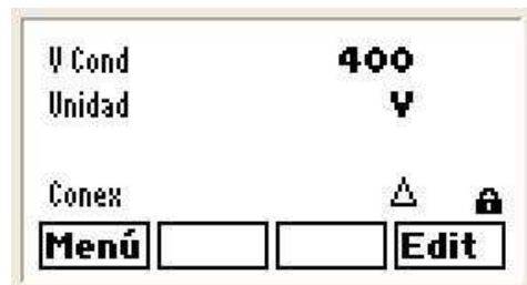
Fig.23.- Programación de la configuración de los condensadores
