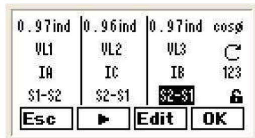
Fig. 41.- Menú de conexión de transformadores cambiado
