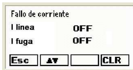
Fig. 96b.- Pantalla de la alarma de fallo de corriente
