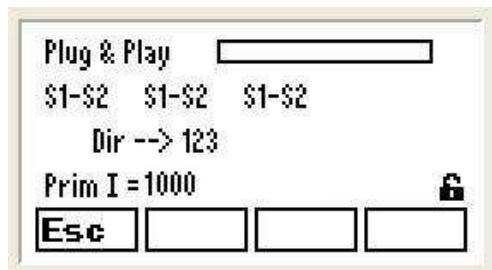
Fig.32.- Plug&Play. Información de secuencia de fases y primario del trafo de corriente
