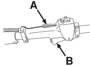
Compruebe que el acelerador esté bloqueado en la posición de ralentí cuando el fiador está en su posición inicial.
