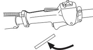
Apriete el fiador del acelerador y compruebe que vuelva a su posición de partida al soltarlo.
