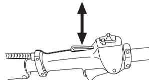
Compruebe que el acelerador y el fiador se muevan con facilidad y que funcionen sus muelles de retorno.
