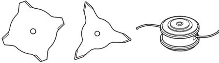
¡Mantenga los dientes de corte de la hoja afilados y en buen estado! Siga nuestras instrucciones y utilice el calibrador de limado recomendado. Una hoja mal afilada o dañada aumenta el peligro de accidentes.
