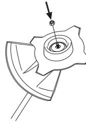
Para el montaje, apriete la tuerca girándola en sentido contrario al sentido de rotación del equipo de corte. Para el desmontaje, afloje la tuerca girándola en el sentido de rotación del equipo de corte. (NOTA: La tuerca tiene rosca a izquierdas.) Apriete la tuerca con la llave para tuerca de la hoja.
