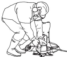
**¡NOTA!** No poner ninguna parte del cuerpo en la superficie marcada. El contacto puede causar quemaduras en la piel o sacudidas eléctricas si el excitador de ignición es defectuoso. Utilice siempre guantes protectores. No emplee nunca una máquina con un excitador de ignición defectuoso.
