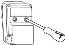
Si el silenciador de su máquina lleva rejilla apagachispas, límpiela a intervalos regulares. La obturación de la rejilla produce el sobrecalentamiento del motor, con el riesgo consiguiente de averías graves.
