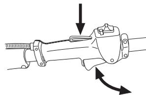
Consulte las instrucciones bajo el título Arranque. Ponga en marcha la máquina y acelere al máximo. Suelte el acelerador y controle que el equipo de corte se detenga y permanezca inmóvil. Si el equipo de corte gira con el acelerador en ralentí, se debe controlar la regulación del carburador para ralentí. Consulte las instrucciones bajo el título Mantenimiento.
