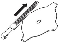
Revise el equipo de corte para ver si está dañado o agrietado. Un equipo de corte dañado debe ser siempre reemplazado.
