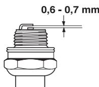
**¡NOTA!** ¡Utilice siempre el tipo de bujía recomendado! Una bujía incorrecta puede arruinar el pistón y el cilindro. Asegúrese de que la bujía tenga supresión de perturbaciones radioeléctricas.
