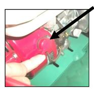
**ON/OFF Switch:** Turn to "ON" before pulling Recoil Rope. *Interruptor de encendido / apa*gado (ON / OFF): coloque el interruptor en ON"antes de tirar de la cuerda.
