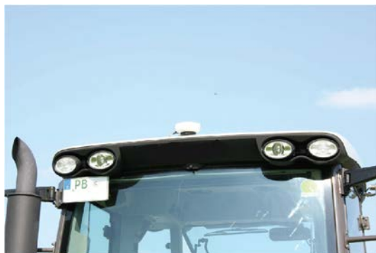
Receptor GPS sobre el techo de un tractor
