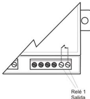
El CCGSM11 dispone de dos relés de salida que permiten gobernar cualquier aparato eléctrico o electrónico cuyas características no superen un consumo de 3A a una tensión de 220 VAC
