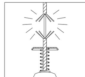
Inspeccionar los alambres, cable, gancho..., antes de utilizarlos para la elevación.
