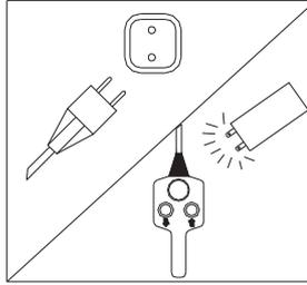
Antes de manipular el aparato comprobar que el aparato está desconectado de la red. Y después de desconectarlo, tener la precaución de descargar los condensadores pulsando en cualquiera de los botones (subir o baja) de la botonera.
