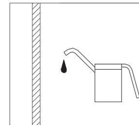
El cable de elevación debe mantenerse siempre bien lubricado.
