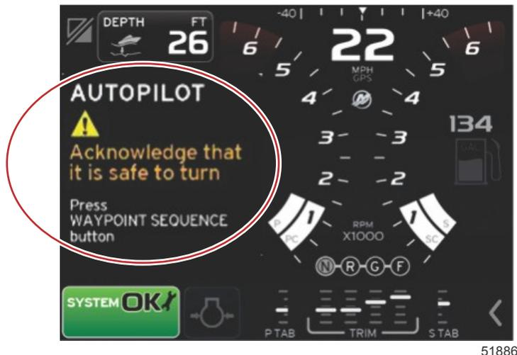
2. Si es seguro cambiar el recorrido hasta la siguiente parada, el usuario tiene que pulsar **SECUENCIA DE PARADA** para aceptar la parada. El piloto automático girará automáticamente la embarcación y realizará las maniobras para seguir el nuevo recorrido.
