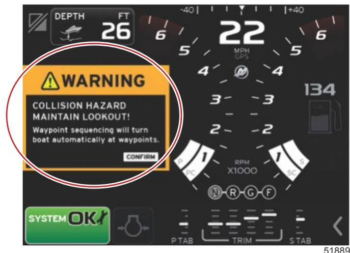
8. Permanezca alerta. La embarcación gira automáticamente en este modo. Debe saber si es seguro girar cuando la embarcación está entrando en una zona de llegada de parada. Informe a los pasajeros de que la embarcación girará automáticamente para que puedan estar preparados.
