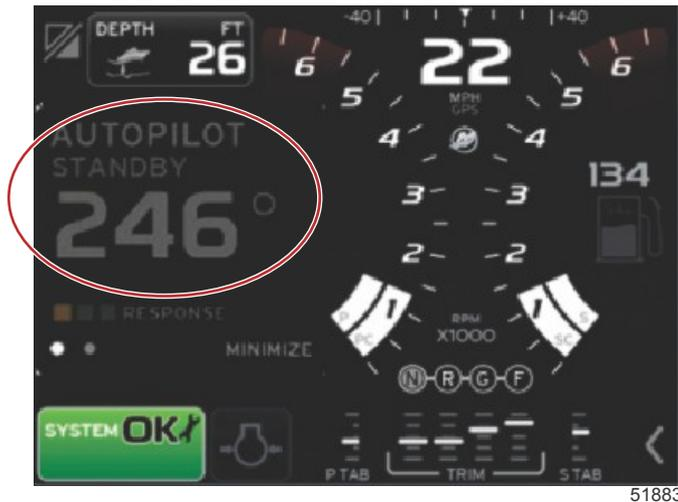
4. Si se enciende la luz del modo de espera y no la luz de reanudación, no puede reanudar el recorrido pulsando el botón de reanudación. Consulte **Para reanudar un rumbo**. Pulse el botón de rumbo automático para salir completamente del modo de rumbo automático.
