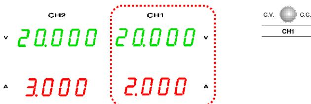
Nivel de tensión La lectura del medidor CH1 muestra la tensión de (CH1) principal salida. En el caso anterior, 20 V.
