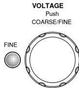
Ajusta el nivel de la tensión de salida para CH1 o CH2. Al pulsar el botón se cambia entre el ajuste aproximado y preciso.
