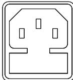
El conector hembra para el cable de alimentación admite la tensión de red AC: 115 V/230 V, 50/60 Hz. Para obtener información sobre el encendido, consulte la página 20.
