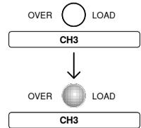
4303S: Cuando el valor de salida sobrepase el valor configurado, el indicador de V.C./C.C. se pondrá en rojo. Esto indica que el CH3 ha pasado de voltaje constante a corriente continua.
