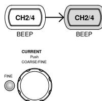
8. Consulte el estado de CV/CC y el nivel de salida (CH2) secundario en el medidor de CH1/CH2 y el indicador CH2.
