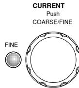
Ajusta el nivel de la corriente de salida para CH1 o CH2. Al pulsar el botón se cambia entre el ajuste aproximado y preciso.
