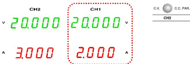
Nivel de tensión La lectura del medidor de CH2 muestra la tensión (CH2) secundaria de salida. En el caso anterior, 20 V.
