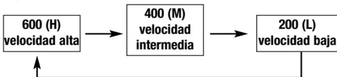
**Aviso:** Al arrancar la unidad, el láser estará en el estado de rotación de alta velocidad. Cuando cambie la velocidad de rotación, el LED correspondiente se encenderá.
