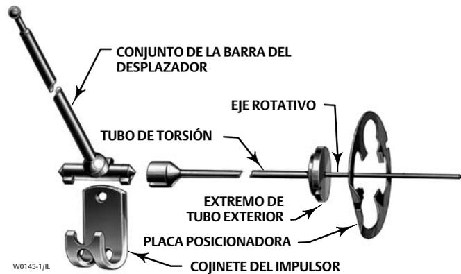
VISTA DE DESPIECE DEL CONJUNTO DE TUBO DE TORSIÓN Y LA BARRA DEL DESPLAZADOR
