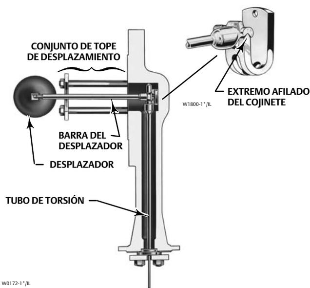
El extremo no conectado del tubo está sellado con una empaquetadura y sujeto rígidamente al brazo del tubo de torsión, permitiendo que el extremo que sobresale del eje oscile y por lo tanto transmita movimiento rotatorio. Esto permite que el interior del tubo de torsión permanezca a la presión atmosférica, eliminando así la necesidad de empaque y las desventajas de la fricción del mismo.
