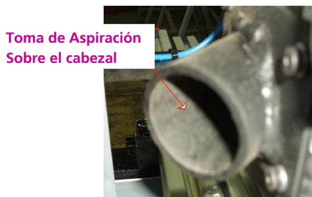
La conexión a la aspiración de la fábrica, será realizada a la toma situada en la parte trasera del grupo de taladro mediante tubo flexible de Diámetro 60.
