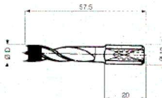
La zona de sujeción de la broca será como la indicada en la figura, no usar casquillos reductores ni ningún tipo de adaptador.
