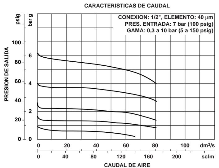
**Datos para el Suministro.** Los modelos aquí incluidos son con rosca ISO cilíndrica, pomo de ajuste, purga automática, depósito metálico con indicador de nivel, elemento de 40 µm, membrana con escape y presión de salida de 0,3 a 10 bar (5 a 150 psig)\*.
