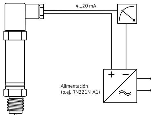
Transductor piezométrico Cerabar T con salida de 4...20 mA y fuente de alimentación auxiliar, como, por ejemplo, la fuente RN221N-A1 de E-direct.
