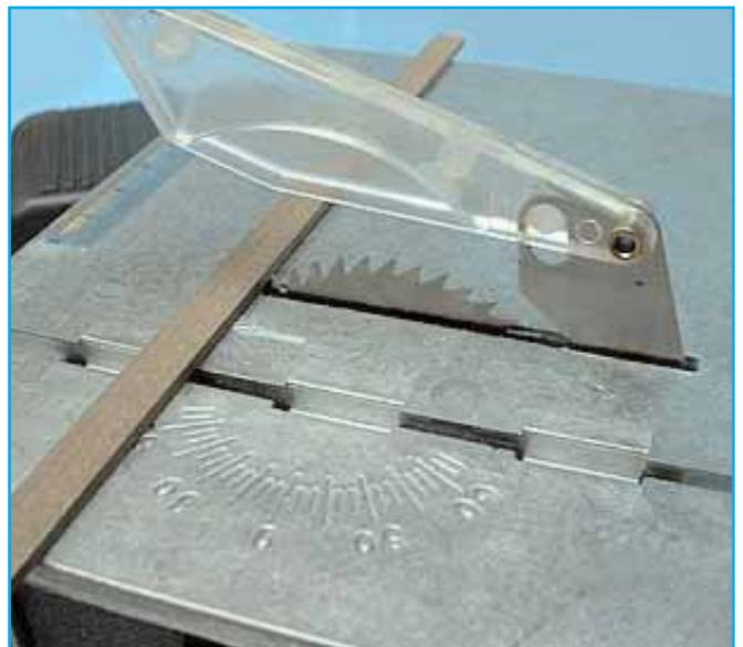
La postura normal del trabajador es frontal a la herramienta, junto a la mesa, y empujando con ambas manos la pieza. Puesto que rara vez la máquina está dotada de guías u otros complementos, el corte se efectúa a pulso. Esta máquina destaca por su sencillez de manejo y precisión de trabajo relativo, lo que facilita su uso por personas no cualificadas que toman confianza hasta el extremo de despreciar su peligrosidad.
