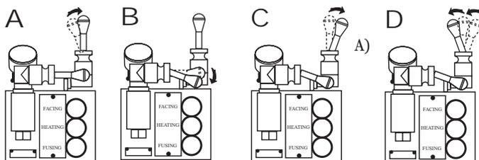
Cambie la válvula de control del carro a la posición neutra, si ya no está en esa posición.
