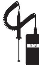
Para la fusión a tope, la temperatura de la superficie del calentador debe estar en un rango que va de un mínimo de 400 °F (204 °C) hasta un máximo de 450 °F (232 °C), en donde el **óptimo es 425 °F (218 °C)**.
