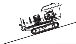
**▲ADVERTENCIA** Para mantener la seguridad en el funcionamiento, nunca opere la máquina en una pendiente de más de 30 %. (3 m de elevación por 10 m de horizontal)
