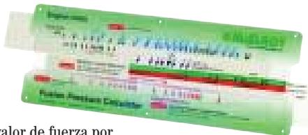
Presión interfacial (IFP) = valor de fuerza por pulgada cuadrada del área superficial del extremo de tubo. La presión interfacial (IFP) y la presión manométrica de la máquina de fusión no son la misma presión.
