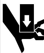
Danger lié aux mouvement. Le vérin à sertir fonctionne à grande vitesse et exerce une grande pression et peut causer des blessures graves. Gardez toute partie du corps loin des pièces en mouvement de l'appareil, particulièrement de la zone T de passage de la tête et du support de la matrice lors du fonctionnement de l'appareil.
