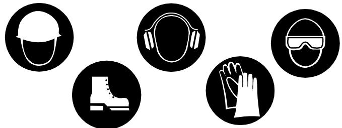
Al manipular, hacer funcionar o dar servicio de mantenimiento a esta herramienta, use todos los equipos de protección personal adecuados, tales como calzado protector, casco, protectores de ojos y de oídos, guantes de trabajo y mangas protectoras.
