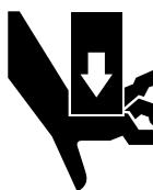
Peligro de machucado. El pistón de engarce funciona a alta velocidad y con mucha potencia y puede ocasionar lesiones graves. Mantenga todas las partes del cuerpo alejadas de las piezas móviles de la herramienta, en especial del riel en T del cabezal y del porta matriz durante la operación.
