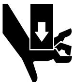
Danger lié aux pinces. Un vérin à sertir fonctionne à grande vitesse et exerce une grande force et peut causer des blessures graves. Gardez toute partie du corps loin des pièces en mouvement de l'appareil, particulièrement de la tête et du support de la matrice lors du fonctionnement de l'appareil.
