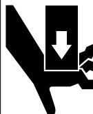
Peligro de machucado. El pistón de mordazas funciona a alta velocidad y con mucha potencia y puede ocasionar lesiones graves. Mantenga todas las partes del cuerpo alejadas de las piezas móviles de la herramienta, en especial del riel en T del cabezal y del porta matriz durante la operación.
