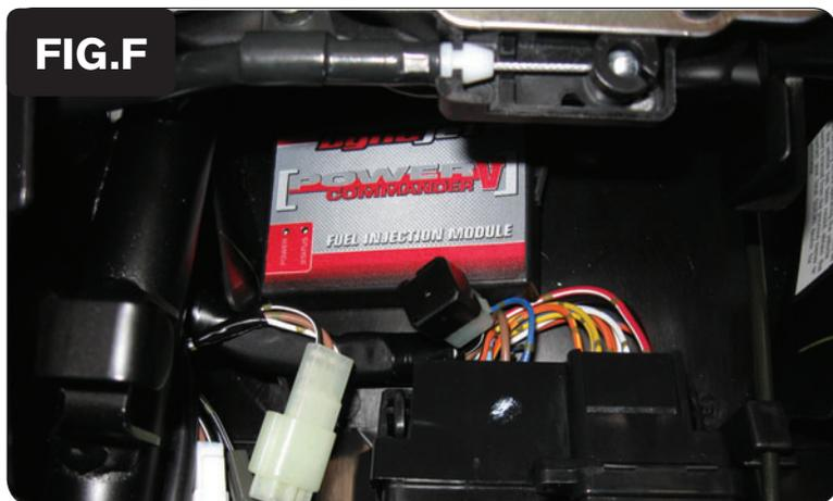
11. Colocar el PCV en la sección de cola, sujetándolo con el velcro que se suministra. Limpiar previamente ambas superficies de contacto con la gamuza con alcohol.
