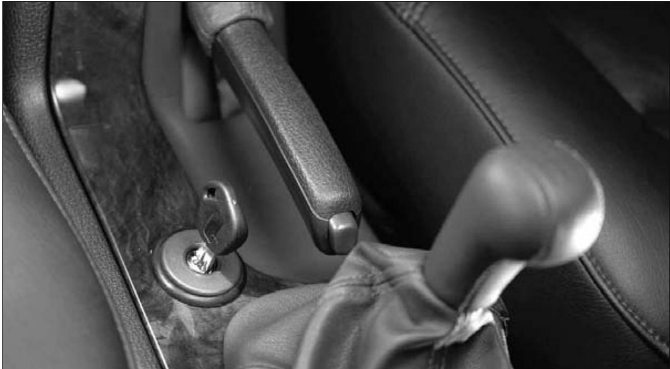
**Leva cambio con serratura****IT****S70, V70, C70, MT –99
