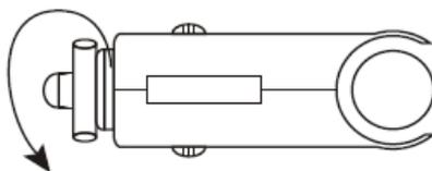
Retire el fusible de seguridad fundido e inserte otro nuevo (hay un fusible extra en el embalaje).
