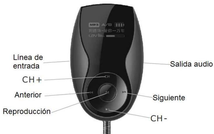
Botones CH+/CH-: pulse brevemente para ajustar la frecuencia en incrementos de 0,1MHz. Mantenga presionado para ajustar la frecuencia en incrementos de 1MHz.
