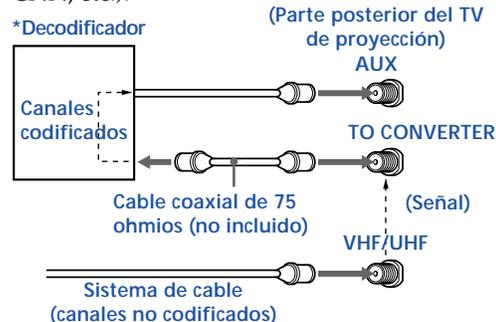
Con esta conexión, puede cambiar entre los canales codificados (a través del decodificador) y los canales normales (CATV). Para ello, oprima el botón ANT del control remoto.
