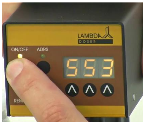
Figura 1-14: Presione el botón On/Off en la unidad del motor después de seleccionar la velocidad de dosificación.
