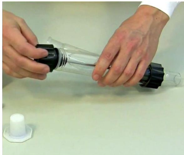
Figura 1-8: Asegure la pieza centradora del eje distribuidor, pasándola a través del eje y con la tapa con rosca al recipiente de vidrio con brazo lateral.
