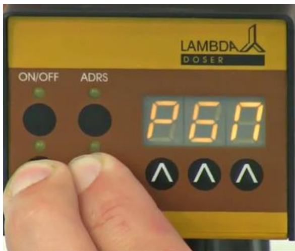
Figura 2-1: Presione los botones REMOTE y RUN simultáneamente hasta que aparezca la indicación "PGM".
