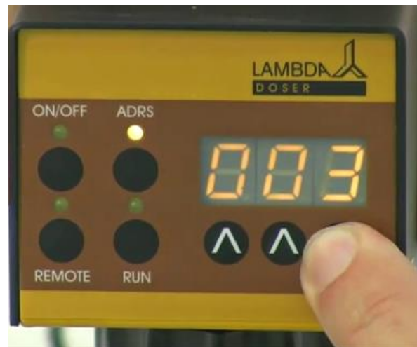
Figura 2-6: Seleccione el periodo de tiempo deseado para el para el primer paso del programa presionando los botones de flechas debajo de la pantalla ▲▲ (desde 0 hasta 999 minutos o 00.0 hasta 99.9 minutos). Presionando el botón ADRS , el tiempo de resolución puede ser ajustado en 0.1 minutos. En el tiempo de resolución de 0.1 minuto se muestra un punto entre los dígitos. ej. "00.1".
