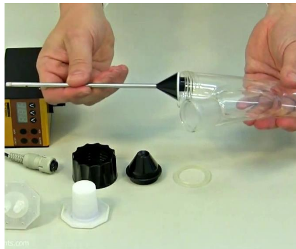
Figura 1-4: Inserte el distribuidor estándar dentro del tubo de vidrio con su abertura directamente hacia abajo de manera tal que este no se dañe.
