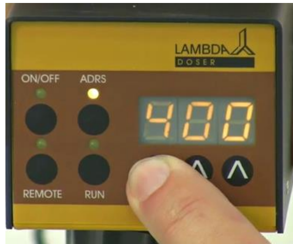
Figura 2-4: Pulse los botones debajo de la pantalla para establecer el valor de caudal deseado (entre 0 y 999, que representa entre 0 y 100% de la velocidad del motor) presionando los botones de flechas ▲▲▲ debajo de la pantalla.
