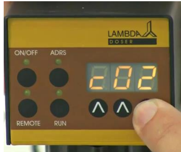
Figura 2-14: Si desea repetir el mismo programa dos veces, incremente el número de ciclos a "c02" presionando los botones de flechas ^ ^ ^ ubicados debajo de la pantalla (ciclos desde 0 hasta 99). El programa puede ser repetido hasta 99 veces indicando "c99" . Si Ud entrase el número 0 lo que es igual a "c00" , el programa estará ejecutándose de manera continua ( lazo infinito ).
