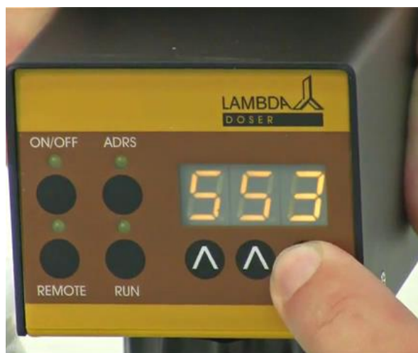
Figura 1-13: Elección de la velocidad de adición de sólido en polvo con ayuda de los botones de flechas \wedge \wedge \wedge .
