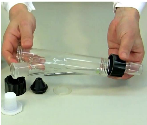
Figura 1-3: Tome el arreglo de piezas anteriores y enrósquelo al recipiente de vidrio con brazo lateral del DOSER.
