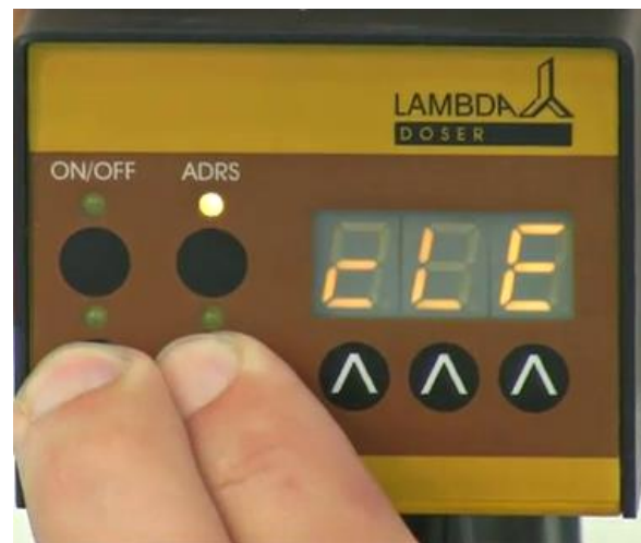
Figura 2-2: Presione continuamente los botones REMOTE y RUN incluso después de que indicación de "PGM" desaparece y aparecerá una indicación con mensaje "cLE".
