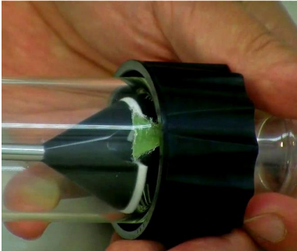
Figura 1-5: Observe que existe un deflector de silicona en la parte inferior del tubo de vidrio. El distribuidor debe colocarse con su apertura frente a este deflector.
