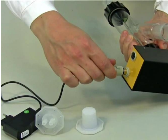
Figura 1-11: El conector de 12 V de la fuente de energía se conecta en el enchufe de 12 V CD de la unidad del motor y la fuente de energía es conectada a su vez a la toma principal.
