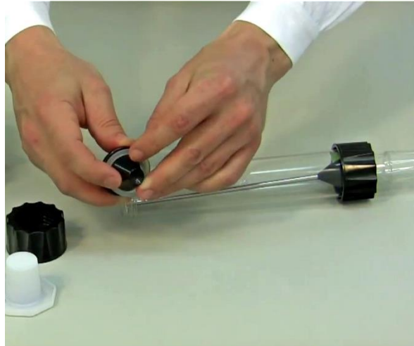
Figura 1-6: El sellador de goma tratado con Teflón se coloca en la pieza centradora del eje distribuidor, con su capa de Teflón orientada hacia afuera (hacia el tubo de vidrio).
