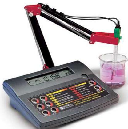
HI 221 e HI 223 se suministran con electrodo rellenable de vidrio HI 1131P (conector BNC y aguja, 1 m de cable), sonda de temperatura de acero HI 7669/2W, soporte electrodos HI 76404, soluciones de calibración pH 4.01 y pH 7.01, solución para relleno electrodo, adaptador de 12 Vdc y manual de instrucciones.
