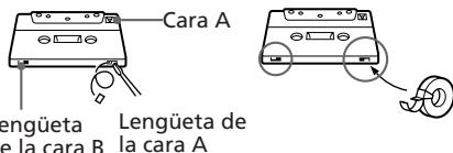
Cuando utilice un cassette de TYPE II (CrO<sub>2</sub>) o TYPE IV (metal), tenga cuidado de no cubrir las ranuras detectoras que permiten al deck detectar automáticamente el tipo de cinta.
