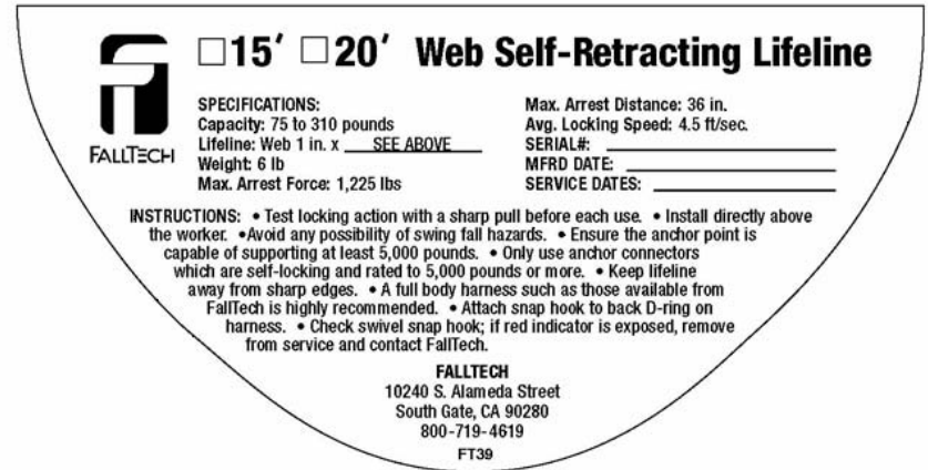
Fig. 10.2 Etiqueta del producto para las SRL de red de FallTech 7270WR, 7271WR y 7270KV (Situada en la cubierta delantera)
