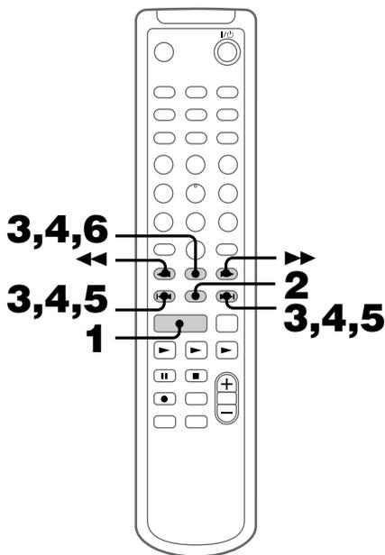
**1** Pulse repetidamente **FUNCTION** para cambiar la función a MD.
