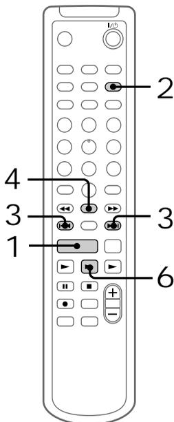
1 Pulse repetidamente **FUNCTION** para cambiar la función a CD.
