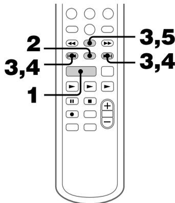
**1** Pulse repetidamente FUNCTION para cambiar la función a MD.
