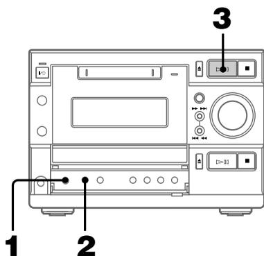
**1** Pulse repetidamente FUNCTION para cambiar la función a MD.
