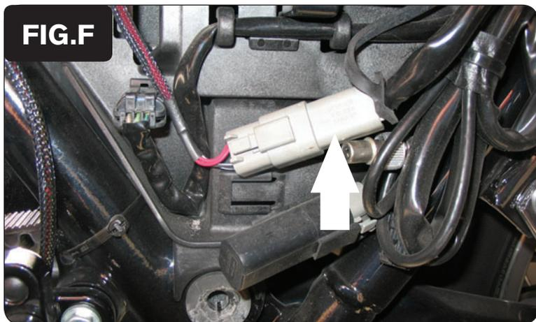
3. Sacar el protector de goma del conector de diagnóstico. Conectar el cable del kit AutoTune al conector de diagnóstico de serie (Fig. F) Esta conexión está debajo de la cubierta lateral izquierda. NO CONECTAR a la conexión de accesorios que se encuentra delante de la batería.
