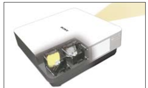
Sistema de lámparas gemelas a prueba de fallos
