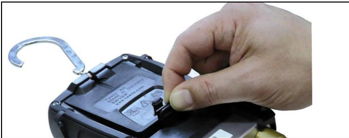
1. Desplegar el dispositivo para colgar, soltar el clip y retirar la tapa el compartimento para pilas.
