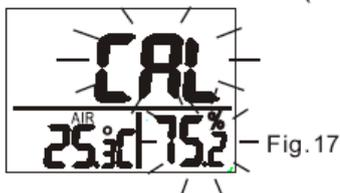
En la parte izquierda de la pantalla LCD parpadearán "CAL" y el valor de calibración (75.2% si está a 25°C) con la temperatura actual.
