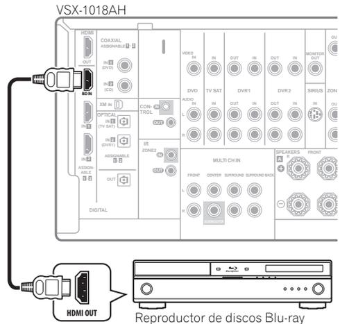
El diagrama muestra la configuración básica para conectar este receptor a un reproductor de discos Blu-ray, con conexiones HDMI. Si su reproductor de discos Blu-ray ofrece salidas de audio analógicas multicanal, consulte *Usando XM Radio* en la página 53.
