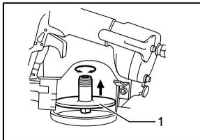
1. Placa de apoyo de la bobina
