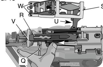
3. Empuje la unidad guía/retorno (R) hacia la tobera y manténgalo en su lugar contra el tope inferior (V) mientras hace rodar hacia atrás a la unidad del brazo de activación (S). Extraiga la unidad del brazo de activación y póngala a un lado.
