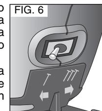
**⚠ PRECAUCIÓN:** Por cada clavo es necesario oprimir el disparador de contacto y luego apretar el gatillo. Después de esto se debe soltar tanto el disparador de contacto como el gatillo por cada clavo.
