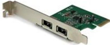
La tarjeta PCI Express FireWire de 2 puertos, modelo PEX1394A2V, permite agregar dos puertos nativos FireWire 400 a un ordenador de sobremesa, lo cual permite conectar dispositivos FireWire IEEE 1394A, como cámaras digitales, discos duros externos, grabadoras de vídeo digital, etc.
