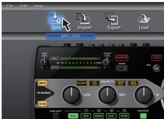
Los datos de parámetros personalizados se cargan en el RMX-1000. Después de cargar, [Sync] aparece en la sección de visualización de BPM del RMX-1000.
