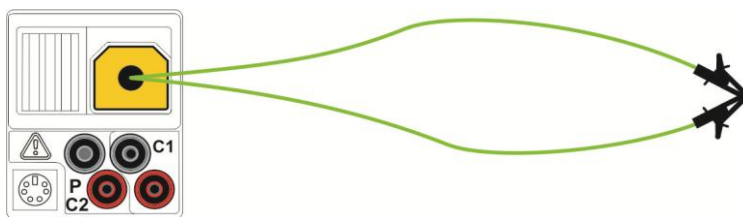
Figura 5.10: Cables de prueba puenteados
