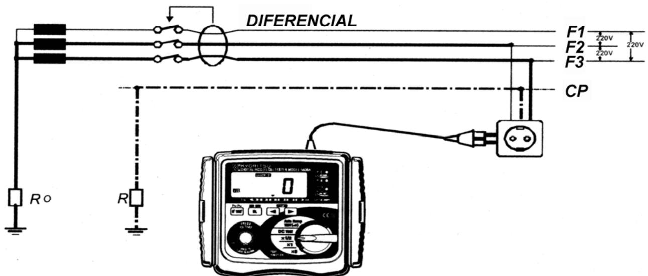
Conectando el Modelo 5406 en este sistema, se iluminarán los tres LEDs de verificación del conexionado.
