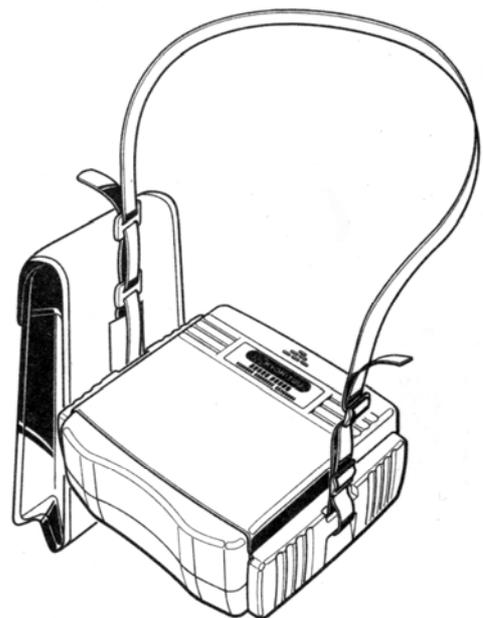
Pase la correa a través de las hebillas, ajuste la correa al tamaño requerido y asegúrela
