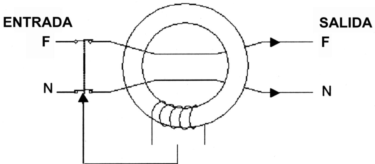
Básicamente existen dos clasificaciones de interruptores diferenciales: El primero sensible a la forma de onda de la intensidad residual (Tipo AC y A) y el segundo sensible al tiempo de disparo (Tipo G y S)
