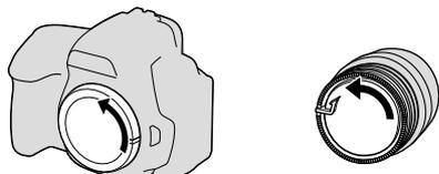
**2** Alinee el índice naranja del tambor del objetivo con el índice naranja de la cámara (índice de montaje) y, a continuación, inserte el objetivo en la montura de la cámara y gírelo hacia la derecha hasta que quede encajado.
