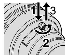
2 Alinee el índice naranja del bloqueo del soporte del filtro con el soporte del filtro, oriente el lado del filtro hacia el cuerpo de la cámara y, a continuación, inserte el soporte del filtro en el tambor del objetivo.
