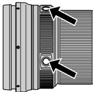
Ajuste el selector para mantener el enfoque/enfoque previo en FOCUS HOLD y pulse el botón para mantener el enfoque.
