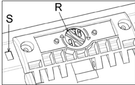
Atención - Mientras está girando la ranura R, asegúrese de que los seguros de antielevación están bien enganchados al tubo octogonal.
