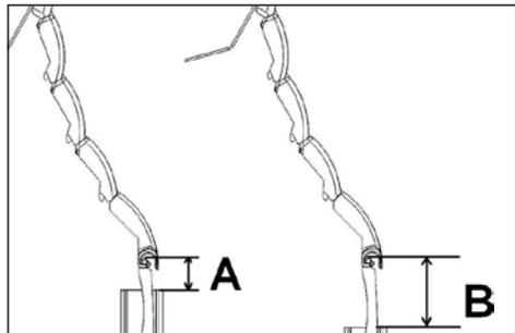
La barra guía superior de la persiana no debe sobresalir menos de 1/3 de la altura del perfil **A** y no más de 2/3 de la altura de perfil **B**, con respecto al riel de guía.
