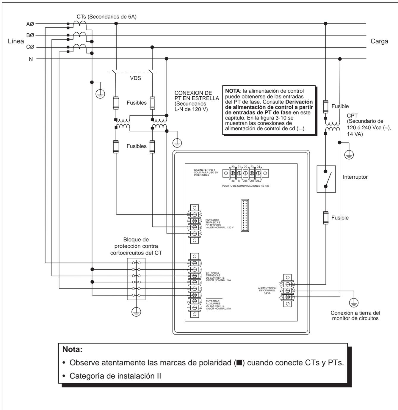
**Figura 3-8: Sistema de medición de dos elementos y medio tipo 42 (neutro calculado)**
