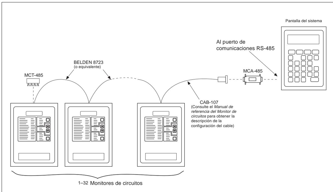
**Figura 3-15: Monitores de circuitos conectados a una pantalla del sistema para monitores de circuitos**
