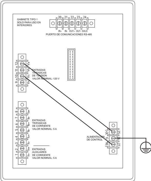
Figura 3-12: Derivación de la alimentación de control L-L de entradas de PT de fase
