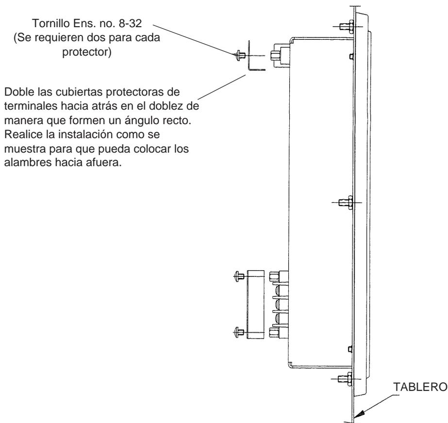
**Figura C-1: Instalación de las cubiertas protectoras de terminales**
