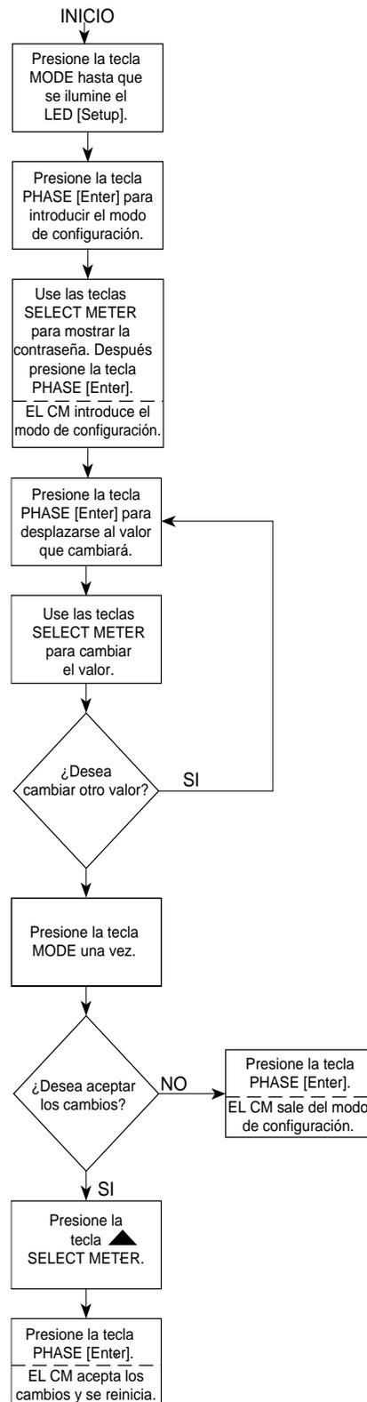
Figura 4-2: Diagrama de flujo de la configuración del Monitor desde la parte frontal
