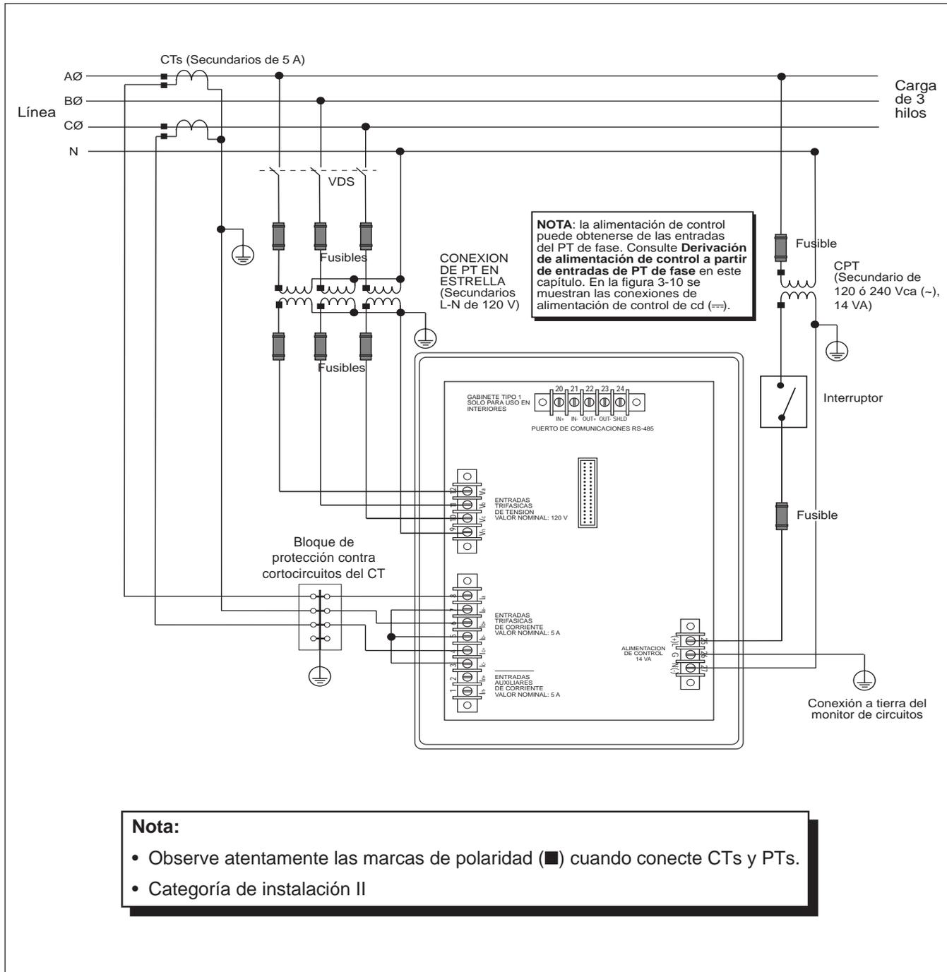
Figura 3-7: Conexión estrella de 3 fases y 4 hilos, carga de 3 hilos
