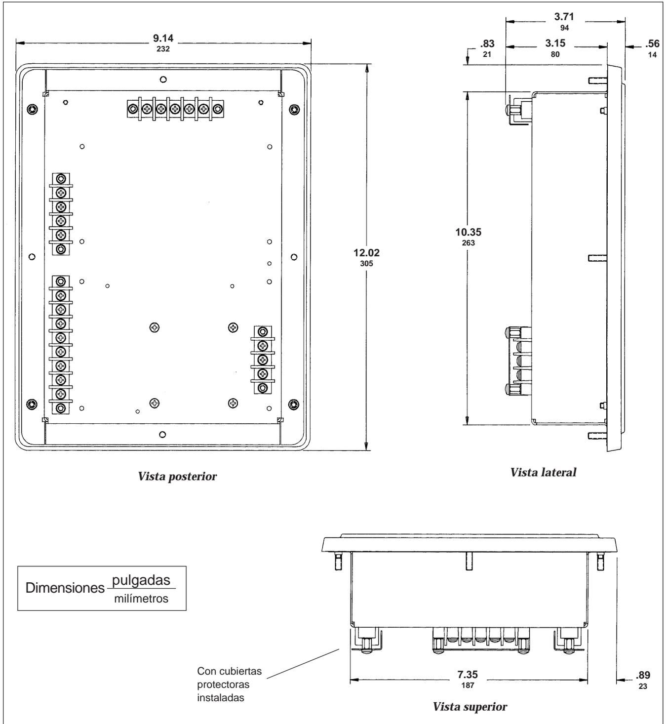
**Figura A-1: Dimensiones del monitor de circuitos**
