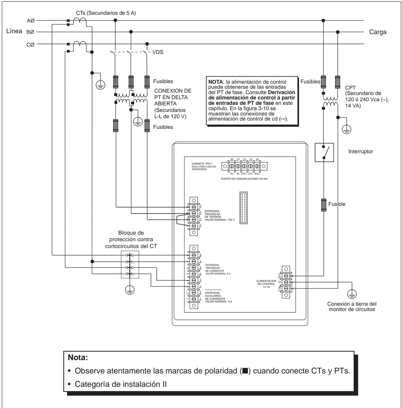
Figura 3-4: Conexión delta de 3 fases y 3 hilos
