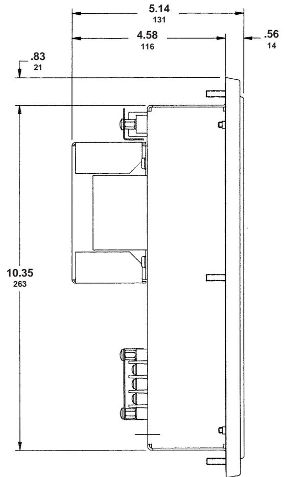
*Figura A-3: Monitor de circuitos con módulo de entrada/salida*
