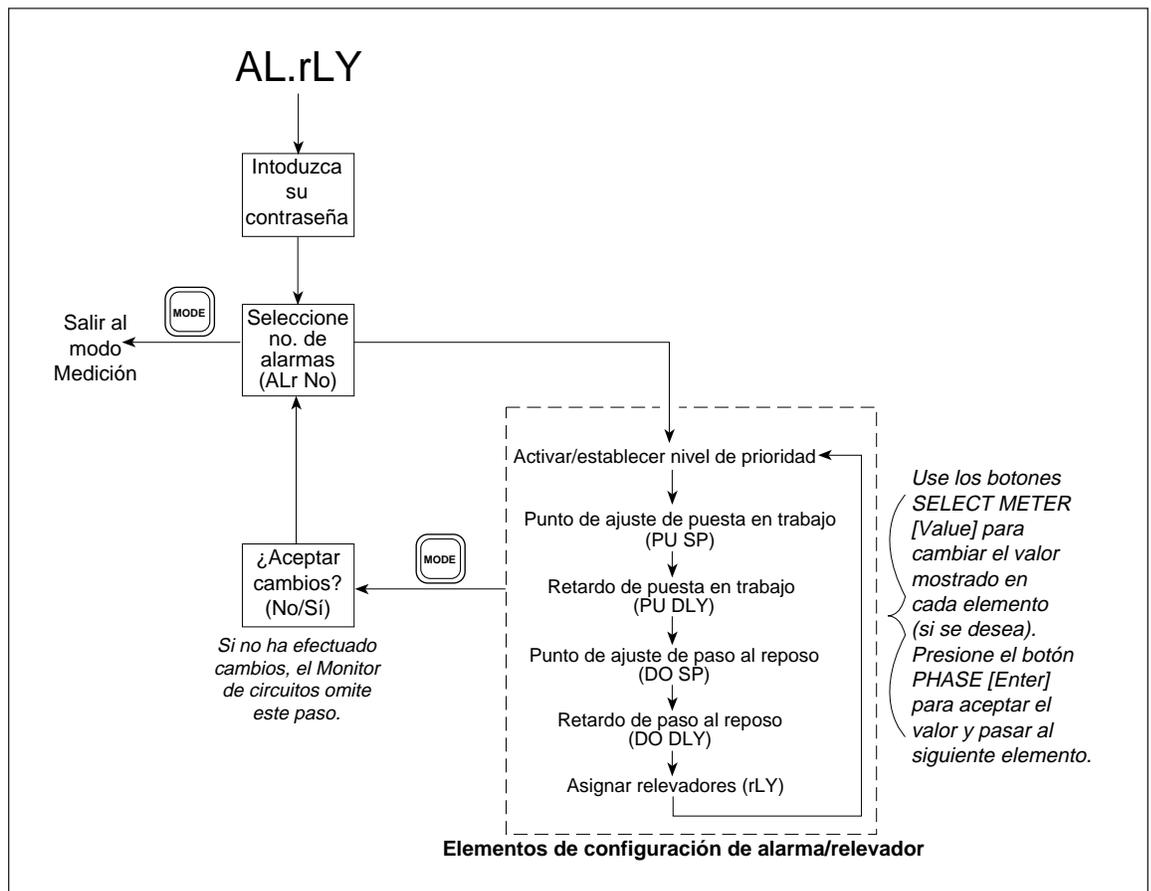
Figura 4-4: Configuración de alarma/relevador (Alarm/Relay)
