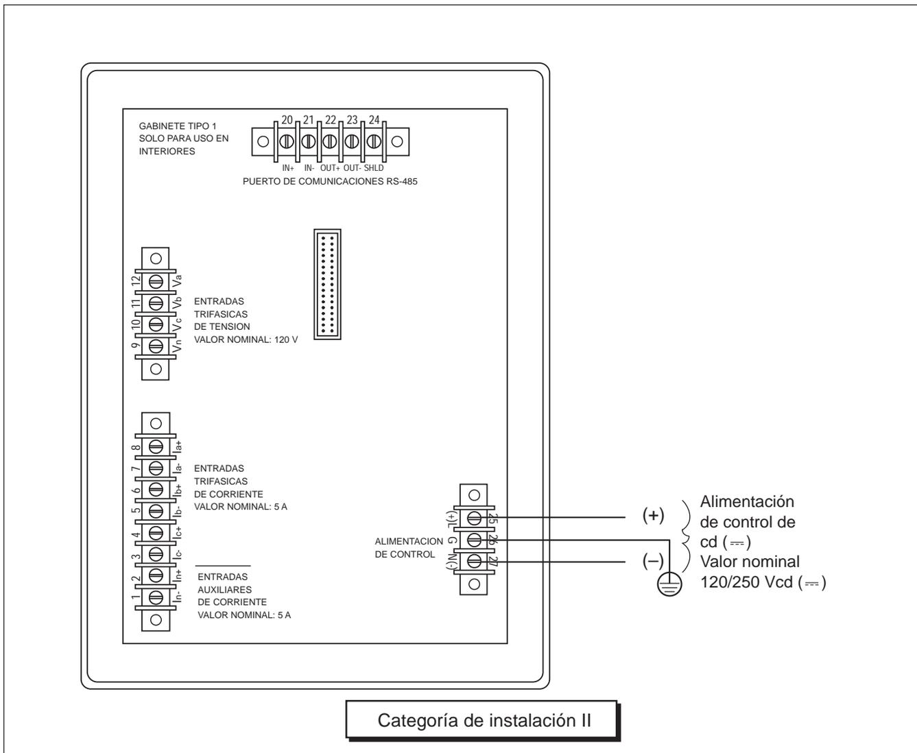
Figura 3-10: Conexiones de alimentación de control de cd (==)
