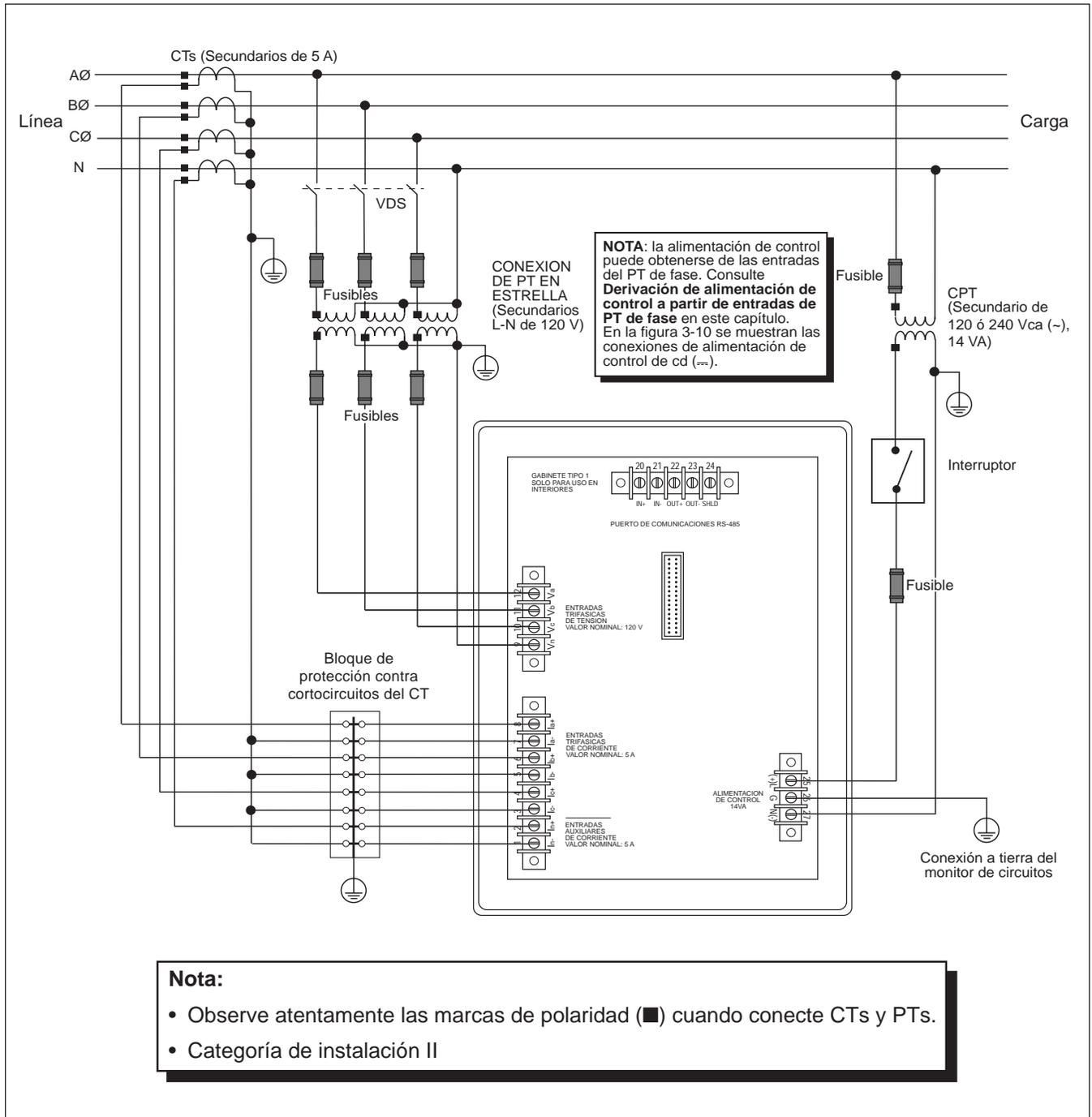
Figura 3-6: Conexión estrella de 3 fases y 4 hilos, conexión a tierra, neutro medido
