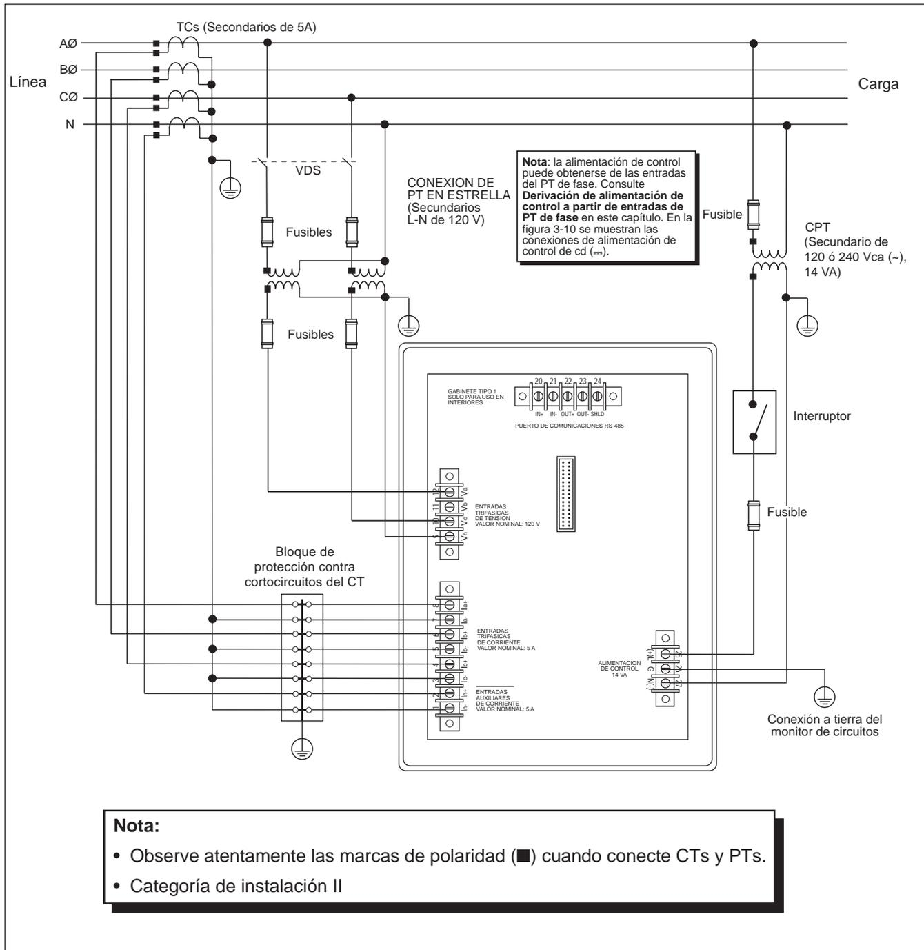
Figura 3-9: Sistema de medición de dos elementos y medio tipo 43
