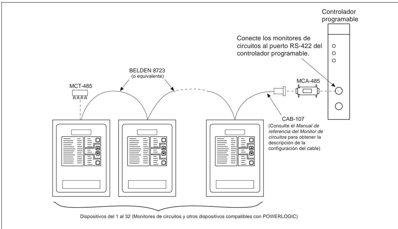
**Figura 3-19: Dispositivos POWERLOGIC conectados a un controlador programable SY/MAX.**
