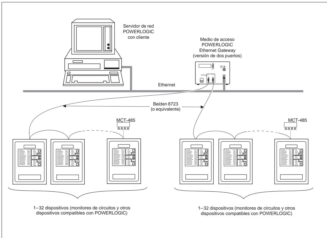
**Figura 3-17: Dispositivos POWERLOGIC conectados a un medio de acceso Ethernet**
