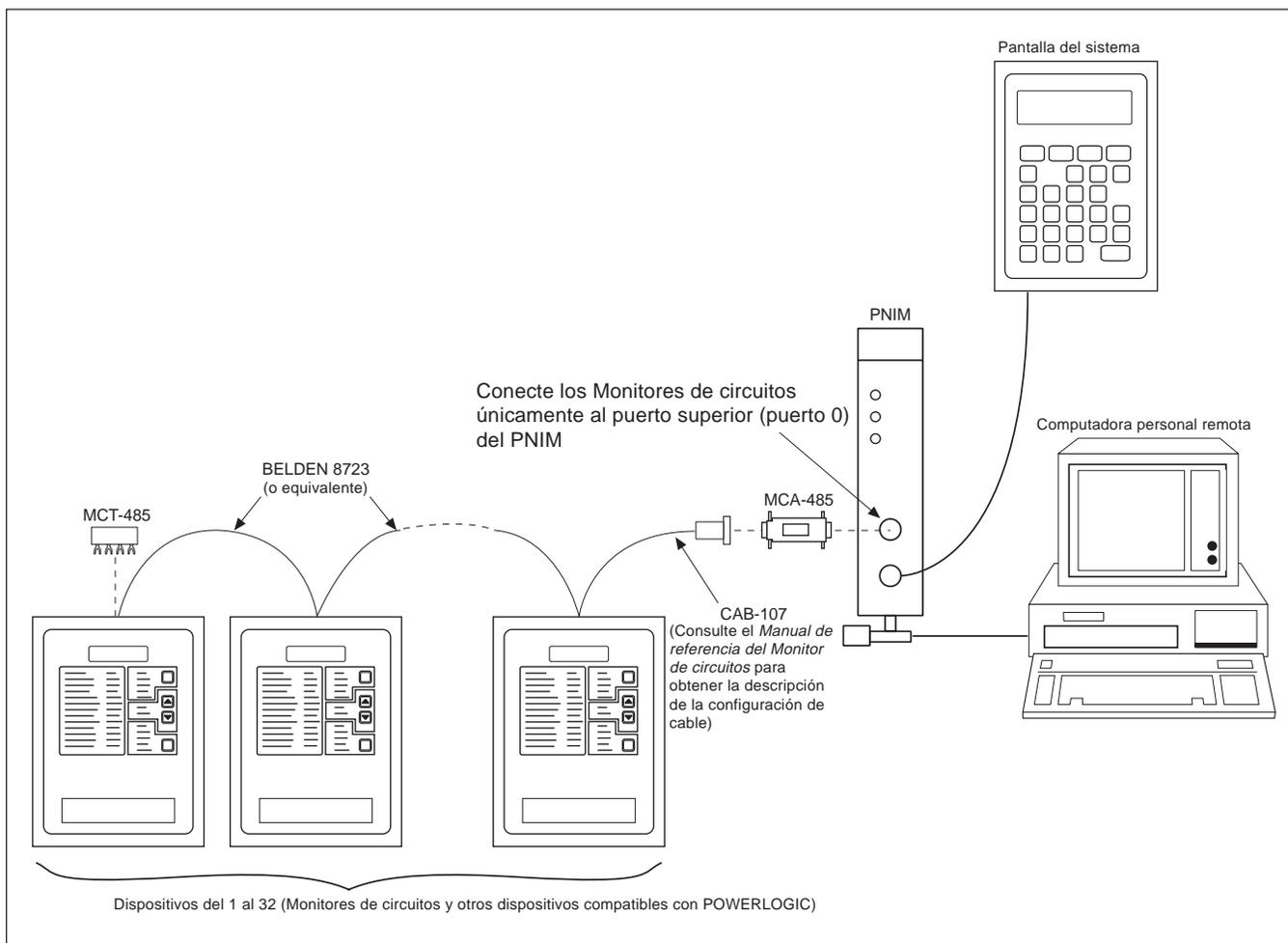
**Figura 3-18: Dispositivos POWERLOGIC conectados a un PNIM**
