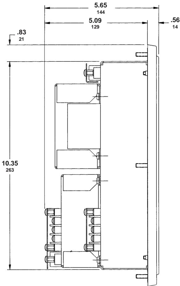
*Figura A-2: Monitor de circuitos con módulos de entrada/salida y de tensión/alimentación*
