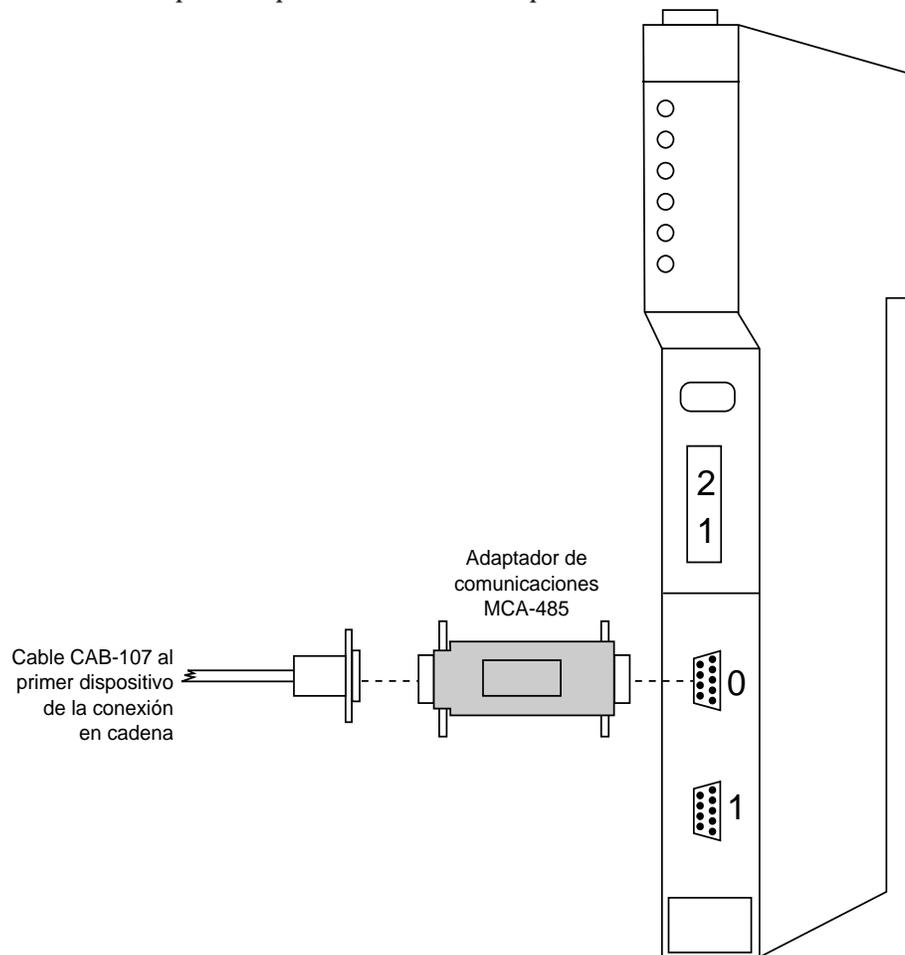
**Figura 3-22: Adaptador de comunicaciones multipunto POWERLOGIC conectado a un PNIM**
