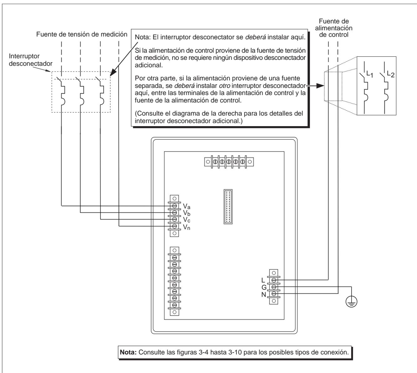
Figura 3-1: Ejemplo de interruptor desconector para cumplimiento de las normas de la CE
