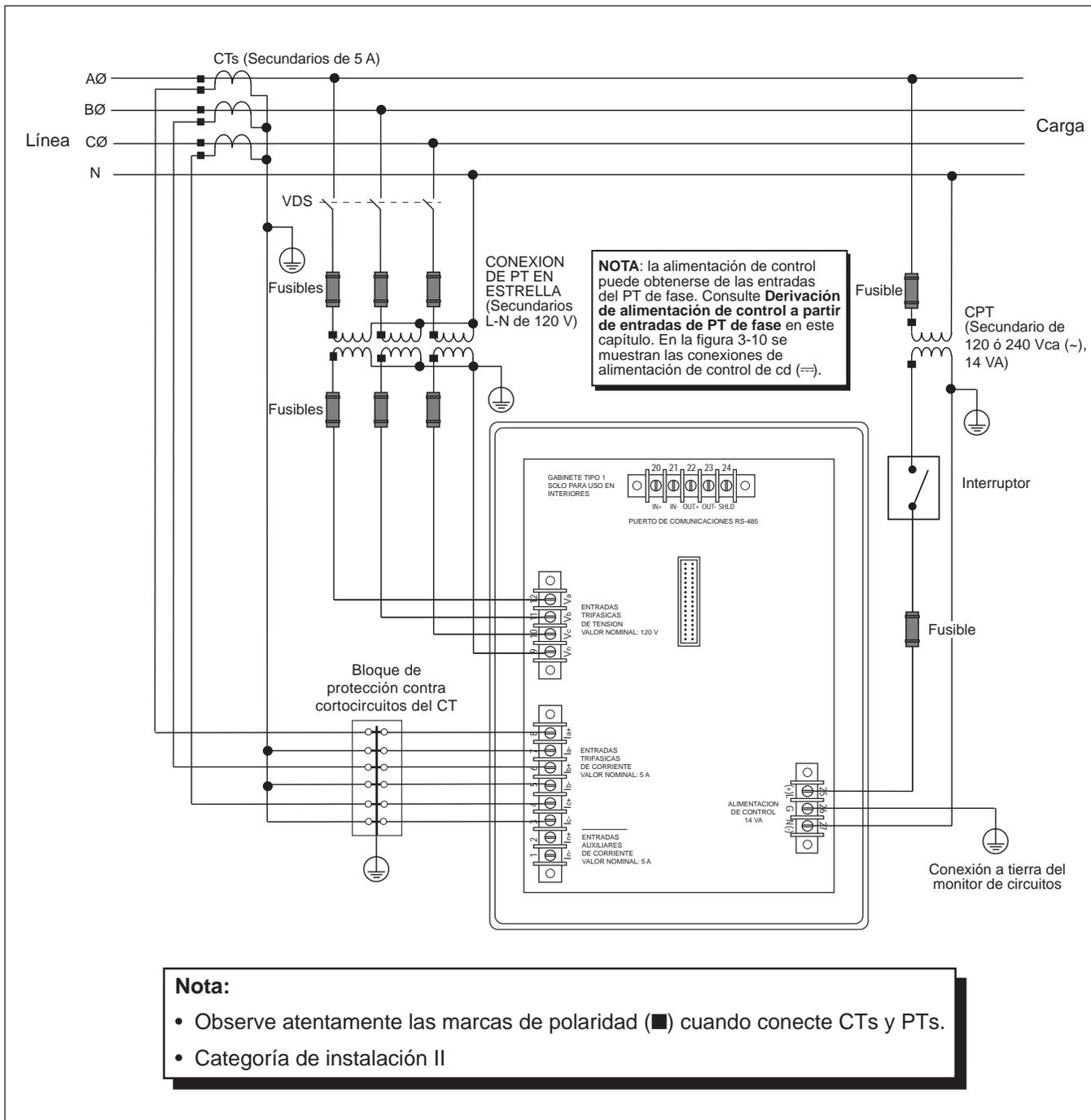
Figura 3-5: Conexión estrella de 3 fases y 4 hilos, conexión a tierra
