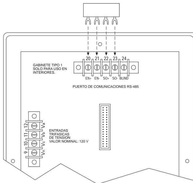
**Figura 3-21: Ubicación del terminador cuando el último dispositivo del enlace es un monitor de circuitos**
