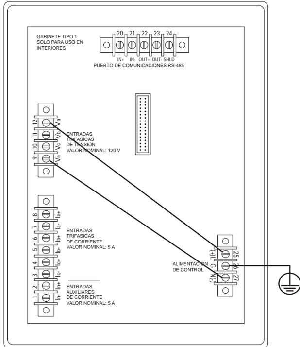
Figura 3-13: Derivación de la alimentación de control L-N de entradas de PT de fase
