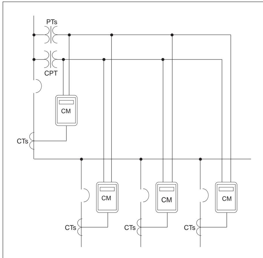
**Figura 3-11: Monitores de circuitos conectados a un montaje único de PTs y un CPT**
