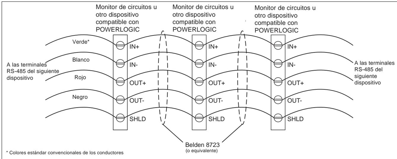
**Figura 3-20: Conexión en cadena de las terminales de comunicación RS-485**
