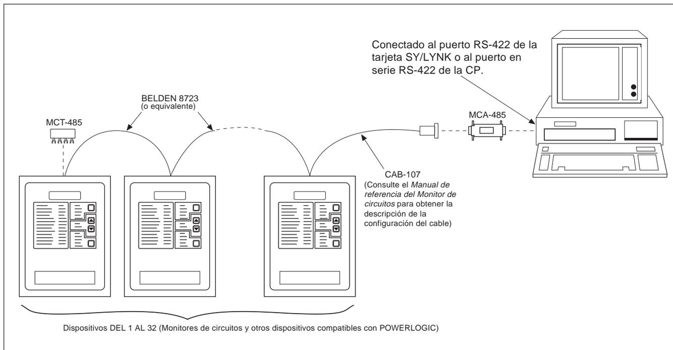
**Figura 3-16: Dispositivos POWERLOGIC conectados directamente a una computadora personal**
