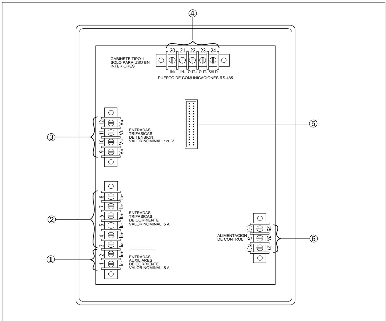
**Figura 2-2: Parte posterior del monitor de circuitos**
