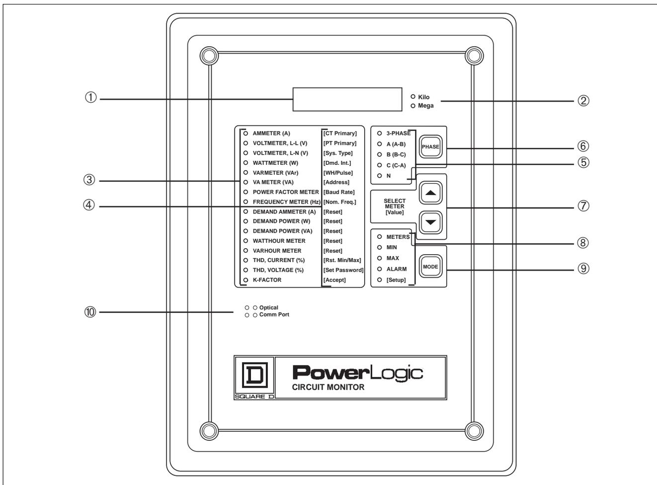
**Figura 2-1: Parte frontal del monitor de circuitos**
