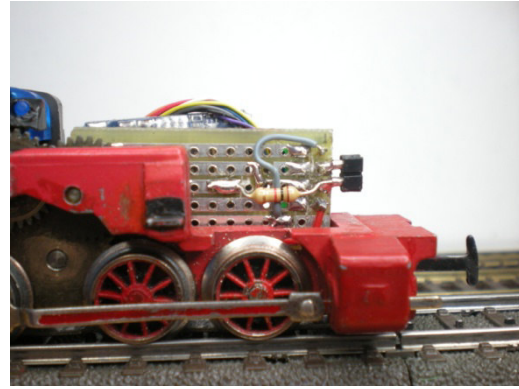
Resistencia y conector(que quitaremos)
