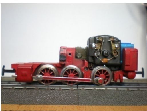
Motor con estator 51961 ESU
