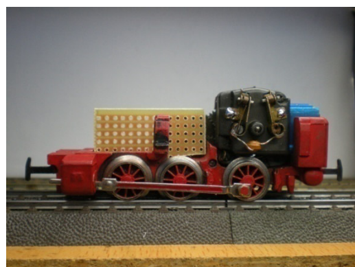
Construyendo la placa NEM 652
