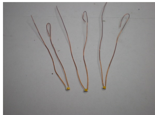
Los tres ledes preparados para montar
