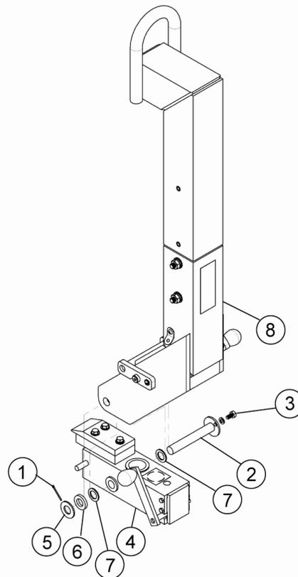
Nota: Limpie las piezas relacionadas y reemplace cualquier pieza gastada de ser necesario. En particular **se requiere reemplazar la clavija hendida**, porque está diseñado para usarse solamente una vez (véase LISTA DE PIEZAS DE REPUESTO).
