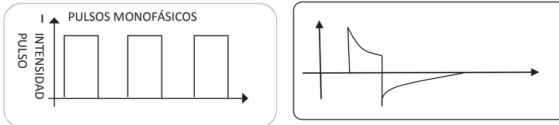
Los dibujos describen la función del tiempo de la intensificación de la corriente, que puede ser monofásica o bifásica. Con pulsos monofásicos, la corriente fluye en sólo una dirección. Con pulsos bifásicos, la corriente cambia su dirección.
