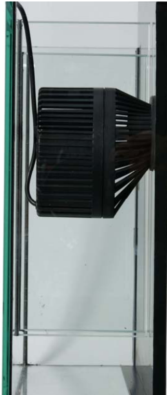
Fig. 1. NanoProp 5000 en la cámara de filtración
